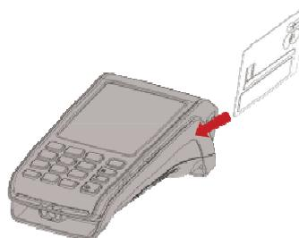
**Magnetstreifenkarten** werden mit dem Magnetstreifen nach links unten zeigend von hinten nach vorne zügig durchgezogen.
